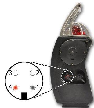
Figura 4: porta de carga local
