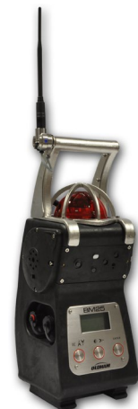
Figura 20 : Versão sem fio, reconhecível pela presença de uma antena
